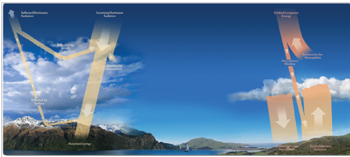
Figura 2 – Balanço Energético Terrestre
