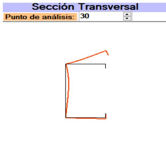
Figura 28. Sección transversal deformada.
