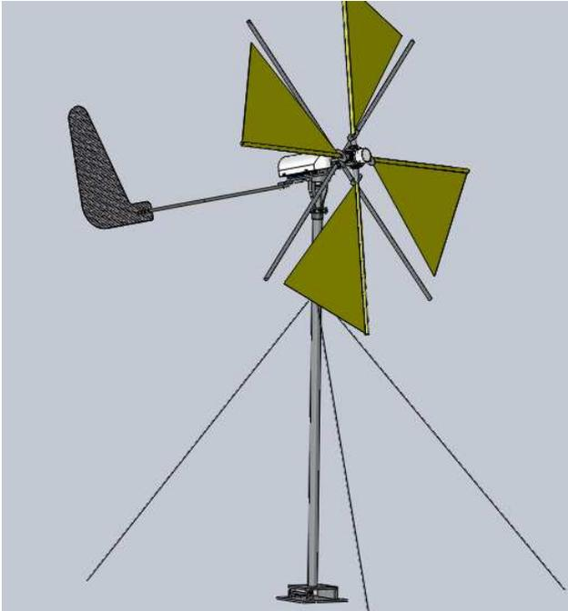
Pretende-se efectuar a monitorização e controlo, com o recurso a um autómato, de um aerogerador que tipicamente aproveita os ventos de baixa intensidade. Este aerogerador recorre a um sistema de velas patenteado, do tipo utilizado num moinho de vento português. Devendo estar em concordância com a norma EN 1050 ao nível do risco eléctrico.
