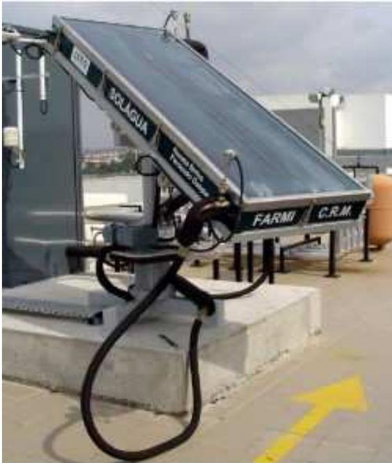
Pretende-se efectuar a reabilitação de um projecto já existente (*SolÁgua*), onde era permitido avaliar o potencial existente na utilização da Energia Solar para aquecimento de água em edifícios residenciais e de serviços.
